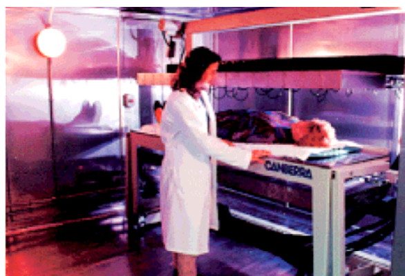
Komora za merenje ukupne količine kalijuma (Univerzitet u Teksasu, USA)
